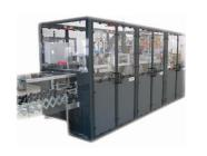
I-Packは、内容品の高さに合わせて ケースの側面を折りたたみ、外ふたで 封函する包装システムです。
